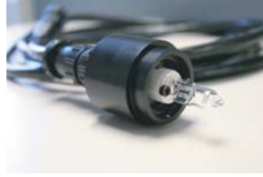
▲ 2π 測定用校正光源 積分球壁面にあるポートに常に設置されます。
