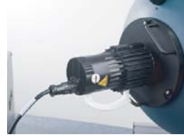
▲ LM-79 推奨 2π 測定用校正光源 2π の配光特性をもつ校正光源です。積分球壁面にある試料ランプポートに設置し、校正後に取り外します。
