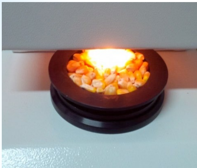
図1：回転するサンプリングカップは、軸方向にオフセットしたサンプリング光学系で照らされています。測定中トウモロコシは回転しています。何回か回転するあいだ、シグナルを統合し、平均化し、サンプル形状、寸法、向き、パラメータ（脂肪質や水分など）の固体内での偏りに依存しない代表的なデータを取得することができます。
