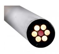
オーシャンオプティクス社の標準反射プローブは、固体表面からの正反射・拡散反射・蛍光測定もしくは溶液や粉末からの後方散乱・蛍光測定に使用されます。これらの標準反射プローブを同社の分光器及び光源と組合せてコンパクトな光学センシングシステムを構築することが可能です。プローブは紫外・可視域 (250 – 800 nm)、可視・近赤外域 (400 – 2100 nm) もしくは両波長域の組合せも可能です。
