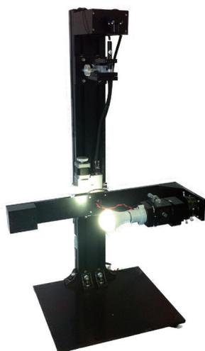
小型配光測定システム OP-GONIO-VIS-SR500 は LED 素子等のサイズの小さなものから、口金 E26 サイズの電球型まで幅広いサイズのサンプルに対応した小型の配光測定システムです。サンプルを水平方向 ( $\varphi$ ) と鉛直方向 ( $\theta$ ) の 2 軸制御を行い、自動で、かつ容易にサンプルの配光測定を行う事が可能です。また、検出器には高感度の電子冷却式裏面入射型分光器を採用しているため、配光分布だけでなく分光放射照度スペクトル、全光束、色測定まで行う事ができます。
