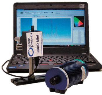
IRRAD-Miniは小型の分光放射照度計です。光源測定に特化した専用ソフトウェアにより、照度の値だけではなく分光放射スペクトル、色度、演色評価数、相関色温度、経時変化特性等の光源評価に必要となる様々な項目に対応し、これまでよりワンランク上の照度測定を実現します。また、手のひらに収まる小型の筐体は研究室から生産工場や植物工場、そして建設現場まで、様々なシーンにおける照明測定に対応します。
