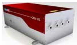
ORIA VIS は Blaze など OPO シグナル光の可変波長幅 (990 ~ 1550 nm) を可視 (495 ~ 775 nm) に容易に変換する、前例のない波長域をカバーしたフェムト秒 2 倍波 (SHG) 発生器です。また、同社製「ORIA IR」と組み合わせることで高い変換効率 (>40%) と優れた安定性を高出力 (>400 mW) で提供します。また、コンパクトな ORIA IVS はパルス幅の広がりを軽減し、優れたスペクトルと空間ビーム品質で幅広いアプリケーションに最適なツールを提供します。
