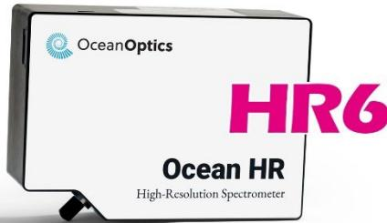
Ocean HR6 分光器は、裏面入射型の 2D CCD を採用し、特に UV 域での感度が向上したファイバ入力式の UV 高感度・高分解能マルチチャンネル分光器です。UV 域での吸光度測定、蛍光測定、プラズマ測定などのアプリケーションに最適です。ユーザ側でスリット交換が可能なため、1 台の分光器で測定に応じた波長分解能、スループットを選択できます。また、クロスプラットフォームソフトウェア開発キット (SDK) である OceanDirect が付属します。
