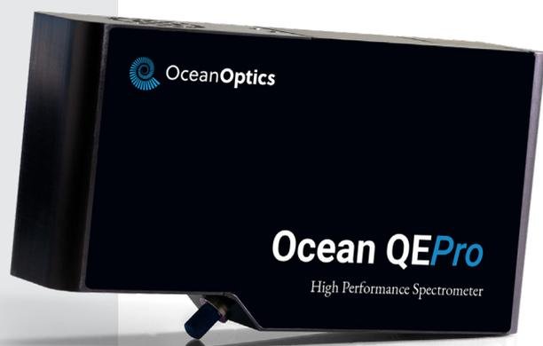
オーシャンオプティクス社の QEPro は、裏面入射型の 2D FFT-CCD を搭載した高感度のマルチチャンネル分光器です。高速データ取得を行うため、最大 15,000 スペクトルのバッファリングが可能です。USB 通信にタイムスタンプ付きのスペクトルをバッファリングすることにより、データの整合性を維持します。また低ノイズのエレクトロニクスと 18bit A/D により、ワイドなダイナミックレンジと高感度を実現しています。入射スリット交換可能な QEPro 分光器は、蛍光測定、DNA 塩基配列、ラマン分光など、高感度を要する測定から、高分解能、高安定性を要する測定まで、さまざまなアプリケーションに最適です。また、オプションで内蔵シャッタの装着が可能となり、測定におけるダークシグナルの取得が容易に行えるため、装置組込み等の光の遮蔽が難しい状態でのアプリケーションに最適です。
