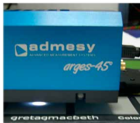
ボトムプレートを外しての非接触測定
