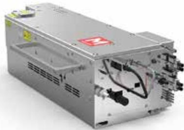
Sprite-XT は既存品にはない高い安定性（ビーム位置・繰り返し周波数・低ノイズ）、信頼性、自動波長可変の超小型フェムト秒チタンサファイアレーザです。独自のミラーマウント設計を取り入れ、励起 DPSS レーザを内蔵しているにもかかわらず、驚異の超小型化に成功し、設置面積（534 × 214 mm）は既存製品の 40 % 以下で、波長可変チタンサファイアレーザとしては世界最小です。これら Sprite-XT の独自設計によりウォームアップ時間が短縮し、オートアライメント動作は格段に減少しました。全制御はイーサネット経由（TCP/IP）による Web ブラウザから操作します。
