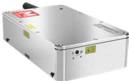
Dragonfly は光励起式半導体ディスクレーザ (SDL) を採用し、920 ~ 1050 nm 域で中心波長を選択可能な、平均出力 1 W のサブピコ秒レーザです。驚異的にコンパクトで軽量、低価格なウルトラファーストレーザの Dragonfly は、特に 2 光子励起 (MPE) アプリケーションに最適です。これまで MPE 顕微鏡用途で主流であったチタンサファイアレーザと比較して、コストを抑え、小型化、使用環境に大きく影響されない特長を有します。また、既存のチタンサファイアレーザの波長帯域に Dragonfly のピンポイントなレーザ波長を追加することで 2 波長励起を可能にします。パルス幅、出力、GVD 補正值などの値はカスタマイズを承ります。お気軽にご相談ください。
