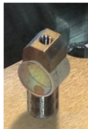
InvarianT(超堅牢独自開発ミラーマウント): モノリシック・インバー・プレートに直接ソルダーリングされ可動部の無いミラー
