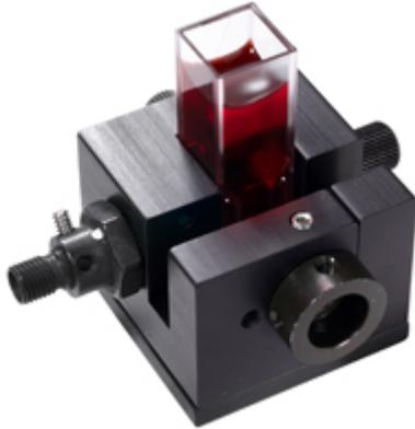
オーシャンインサイト社の CUV-FL-DA は、同社製の光源に直接装着可能な透過・吸光度測定、蛍光測定に対応した 1 cm 角キュベット用のホルダです。サンプルからの透過光・蛍光を SMA 905 規格の光ファイバを使用して分光器へ導きます。波長範囲 200 - 2000 nm に対応しており、紫外域～近赤外域まで幅広い波長範囲でご利用可能です。
