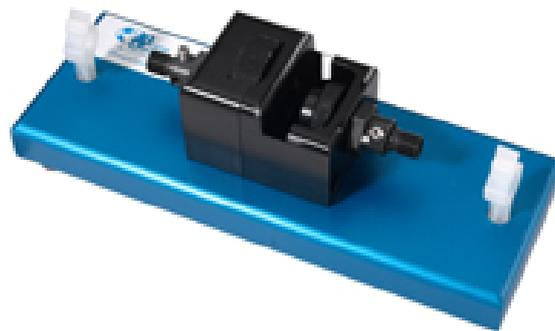
本ホルダには厚さ 6mm までの 1 インチの円形及び 1/2 インチ以上の角型のフィルタが装着出来ます。ベースに立っているプラスチックは SMA コネクタ付ファイバ固定用です。
