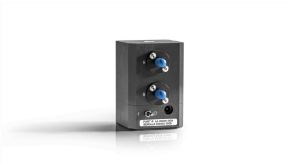
オーシャンインサイト社の ISP-REF は、平面の色測定等に反射測定用積分球として使用可能です。内径 1.5 インチ積分球、ファイバの視野角を制限した光学系、0.4 インチサンプルポート、12 VDC 電源付きハロゲン光源が内蔵されています。内部の材質は、ランバート反射特性の高い、白い拡散材のスペクトラロンとなっています。トグルスイッチで容易に正反射成分を含むか除去するかを選択も可能な機能を備えています。
