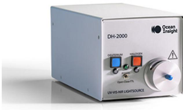
オーシャンインサイト社の DH-2000 は、190~2500 nm の広範囲な光を高出力で安定して出力可能な重水素とハロゲンの組合せ光源です。本光源は、一つの出射口からハロゲンと重水素の連続光を出射可能です。出射口は、オーシャンインサイト社製品の分光器、光ファイバ、キュベットホルダ等のアクセサリと共通で使用可能な SMA 905 コネクタとなっています。
