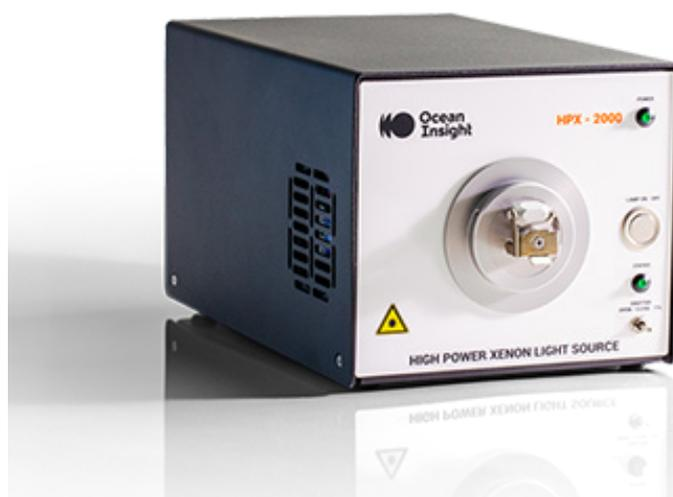
オーシャンインサイト（旧オーシャンオプティクス）社製 HPX-2000 高項出力キセノン光源は、蛍光測定の励起光源として、また高出力の光源が必要な測定に使用可能です。紫外から近赤外（185nm- 2200nm）の範囲の連続光を出力するショートアーク光源です。手動スイッチまたは TTL 信号によって内蔵シャッタの制御が可能です。
