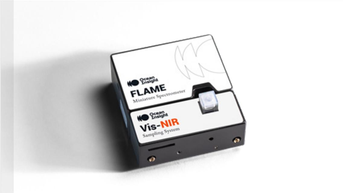
FLAME-CHEM-VIS-NIR 可視～近赤外教育用分光光度計は、PC インタフェースに USB を採用しプラグアンドプレイを実現した、小型で低価格のファイバ入力式マルチチャンネル分光器とモジュール式の可視～近赤外光源を組み合わせた簡易型の分光光度計です。Flame-S-VIS-NIR-ES 分光器とダイレクトアタッチのキュベットホルダ付ハロゲン / 紫色 LED 光源の構成で、より容易な溶液の透過率、吸光度測定を実現しています。
