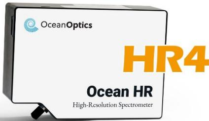
Ocean HR4は、3648素子リニアシリコンCCDアレイディテクタを搭載した、紫外～可視～近赤外域に対応した高分解能タイプのファイバ入力型マルチチャンネル分光器です。線幅の狭いレーザモニタやプラスマの発光測定など、高い波長分解能が必要とされるアプリケーションに最適です。また、クロスプラットフォームソフトウェア開発キット（SDK）であるOceanDirect が付属します。
